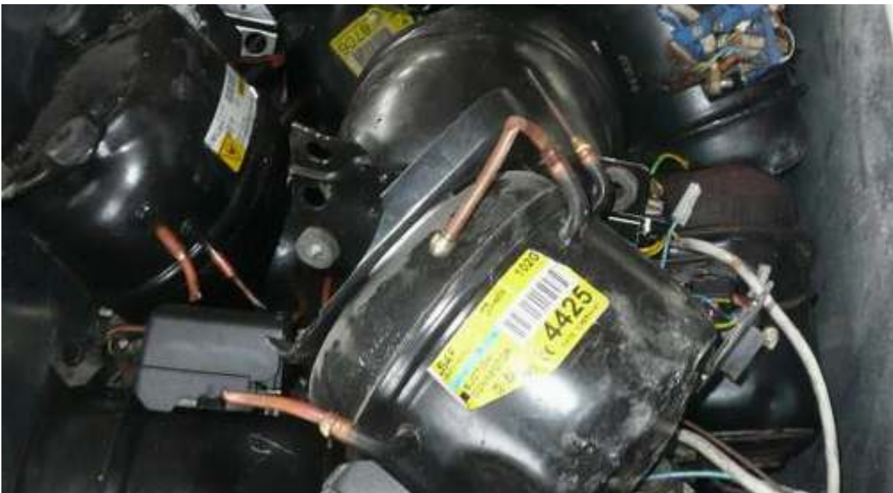
Alte Kompressoren mit unterschiedlichen Kältemitteln, kein Prüfzertifikat, keine Verpackung – gefährlicher Abfall Old compressors containing different types of refrigerants, no certificate of testing, no packaging – hazardous waste (Photo: Hessische Abfalltransportdatenbank)
