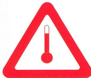
Kennzeichen für erwärmte Stoffe
