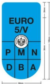
P = Partikelfilter (Vorlage eines Teilegutachtens und eines Nachweises des fachkundigen Einbaus)
