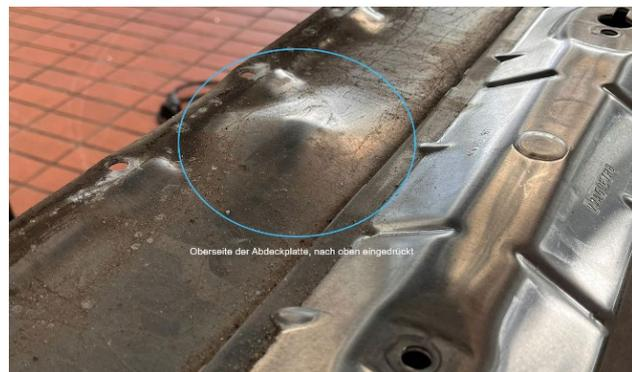
In den uns bekannten Kalkulationssystemen ist dieses Bauteil nicht separat gelistet, es ist lediglich möglich ein Ober- bzw. Unterteil des Batterie-Gehäuses mit entsprechend hohem Umbaufwand von 211 AW (inkl. Nebenarbeiten) auszuwählen (Stand 09/23).
