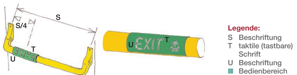
Bild 16: Panikstange mit Fluchtwegkennzeichnung visuell und taktil
