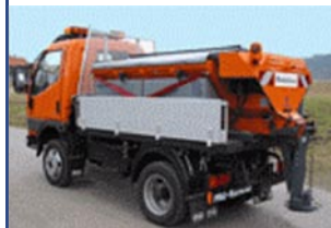
Aufsatzstreuer mit Feuchtsalztechnik
