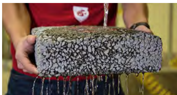
Regenwasser sickert dank des neuen Verfahrens durch den Beton; Foto: © wsu.edu/WSU insider
