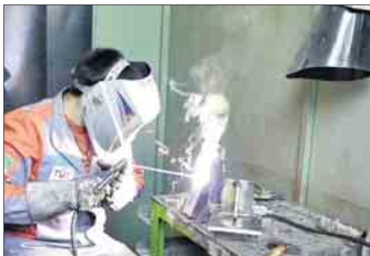
Jung-Schweißer beim Fertigen eines Prüfstückes.
