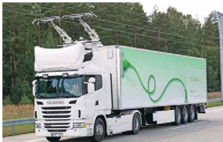
Elektrifizierung des Straßengüterverkehrs – Siemens testet mit Scania das eHighway-System. Die Energieversorgung basiert auf erprobter Technologie aus der Bahnelektrifizierung. Das zweipolige System der Fahrleitungsanlage sorgt dabei für eine zuverlässige Stromversorgung. Foto: Siemens
