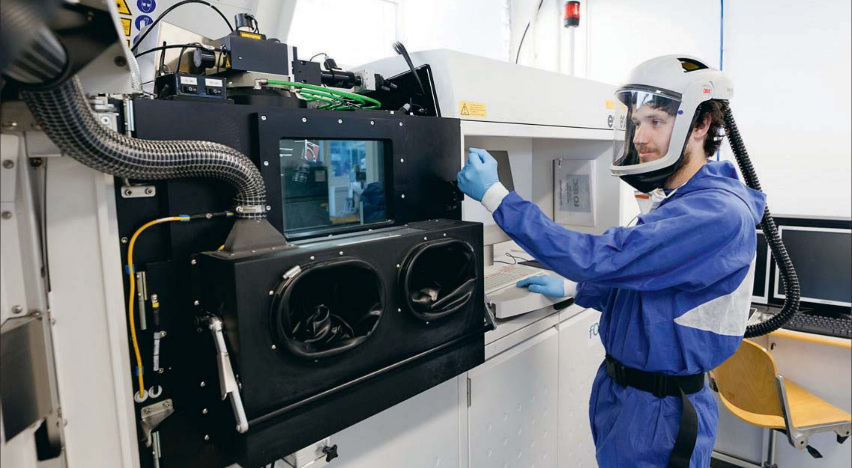
Ein FOTEC-Technologe beim Warten der Laserstrahlschmelzanlage vom Typ EOS M280 für den 3D-Druck von Metallen.
