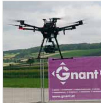
Um Erdbewegungen genau kalkulieren zu können, setzt man bei Gnant Drohnen ein. Fotos: NÖBEG
