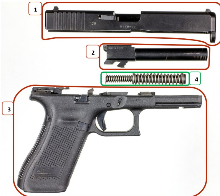
Abbildung 31: Glock 17, Hauptbestandteile der Pistole
