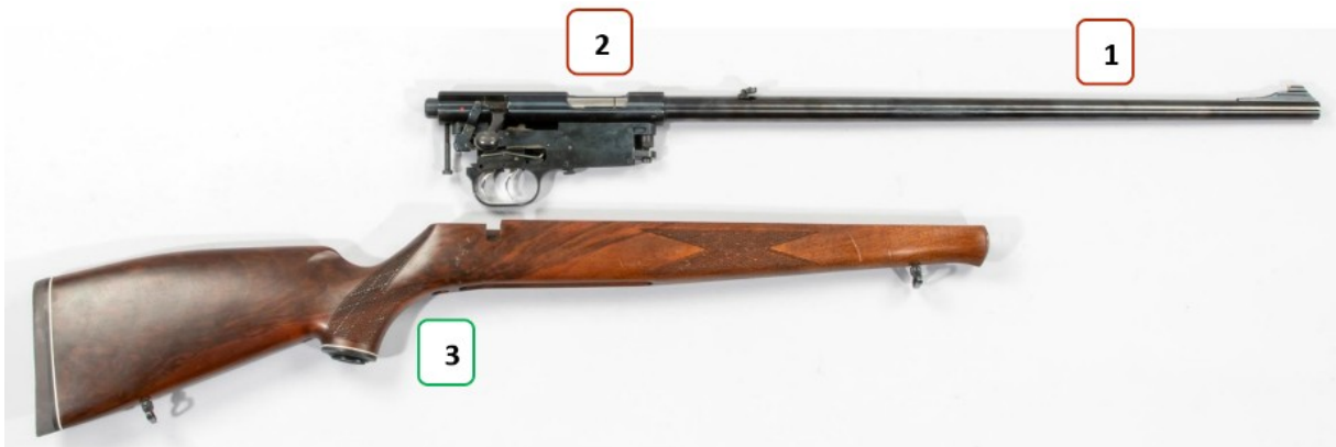
Abbildung 15: Repetierbüchse, Hauptbestandteile der Waffe
