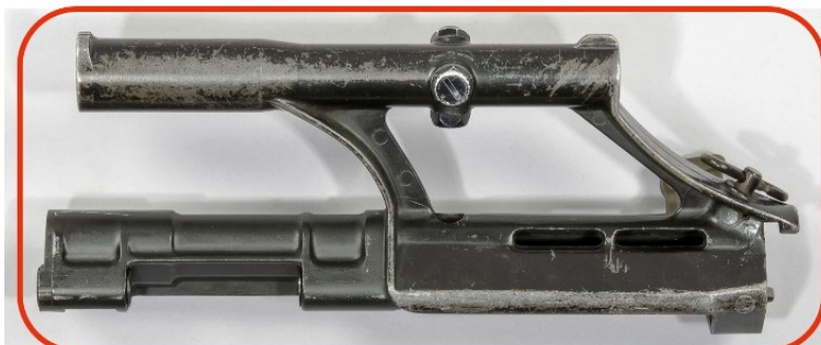
Abbildung 4: AUG Z, Gehäuseoberteil mit integrierter Optik
