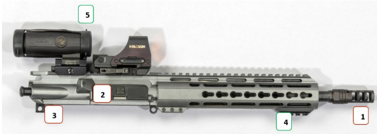
Abbildung 10: AR-15, Gehäuse-Lauf-Einheit (GLE)
