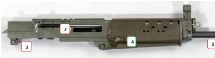
Abbildung 12: SIG-550, Gehäuse-Lauf-Einheit (GLE)
