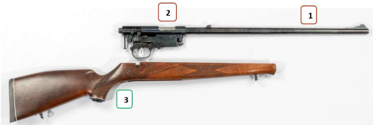
Abbildung 28: Repetierbüchse, Hauptbestandteile der Waffe
