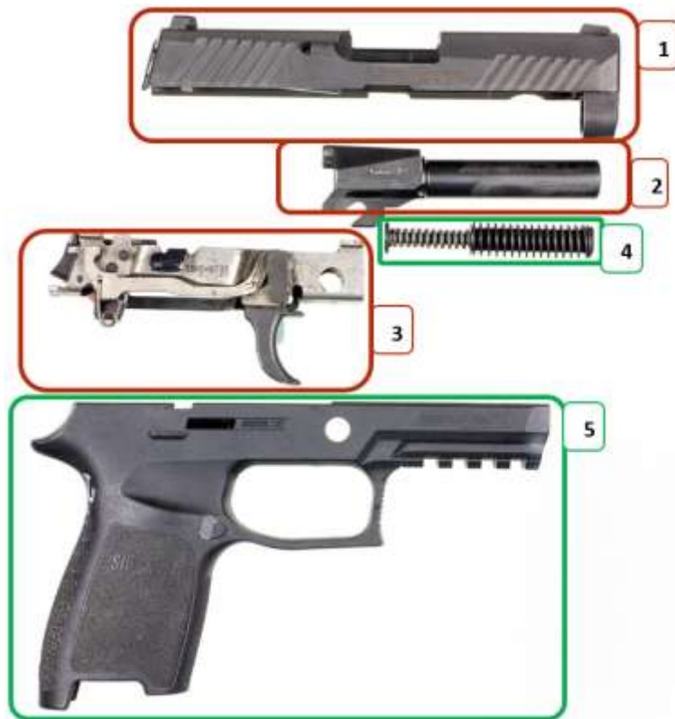
Abbildung 38: SIG P320, Hauptbestandteile der Pistole
