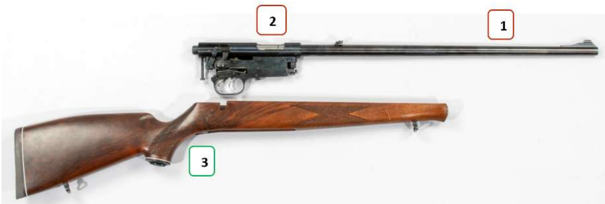
Abbildung 15: Repetierbüchse, Hauptbestandteile der Waffe
