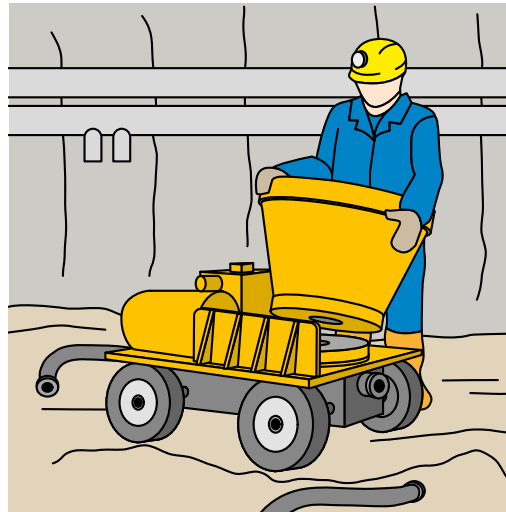
Reinigung der Spritzbetonmaschine
