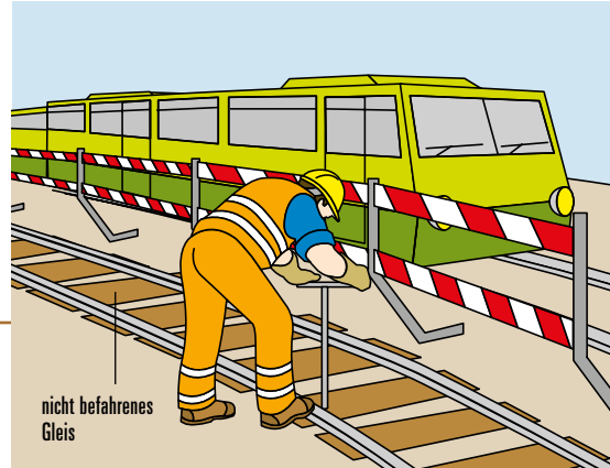
Feste Abspernung zwischen Betriebsgleis und gesperrtem Arbeitsgleis
