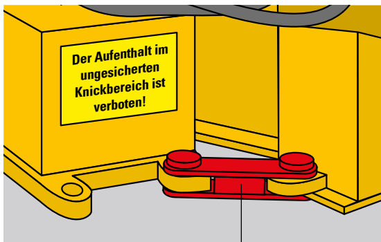
Sicherung des Knickgelenkes
