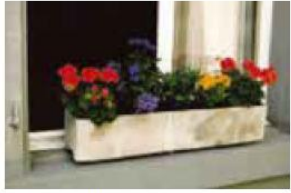
Blumenkisten aus Asbestzement
