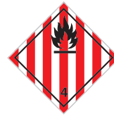
Klasse 4.1 Entzündbare feste Stoffe, selbsterzetzliche Stoffe, polymerisierende Stoffe und desensibilisierte explosive feste Stoffe
