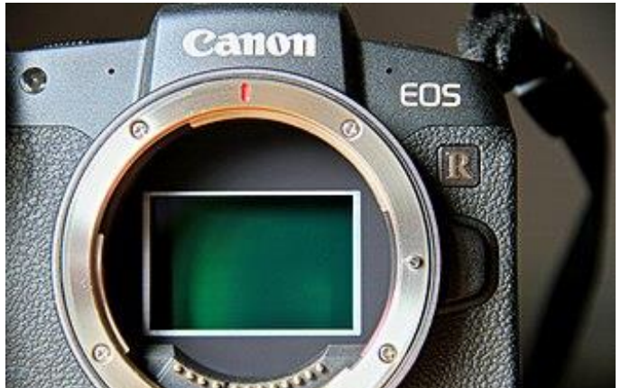
Bild: „26.2 MP CMOS full-frame sensor of Canon mirrorless RP camera“ von Islander61, Wikimedia Commons, lizenziert unter CC BY-SA 4.0
