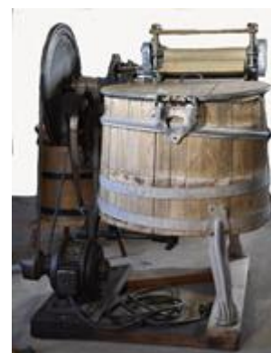
Abbildung 2: Holzbottichwaschmaschine mit Elektromotor - Christoph Rieder
