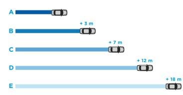
Vollbremsung aus 80 km/h bis Stillstand.
