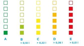
Liter Mehrverbrauch an Kraftstoff auf 100 km bei einem Verbauch von Ø 6,6 I in Bezug auf einen Reifen der Klasse A.
