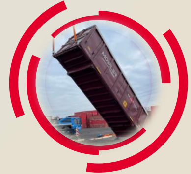
Belastungstest für Fertigware im Rundlauf mit Siedlungsabfällen
