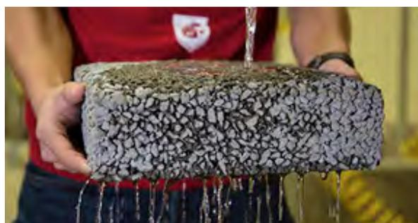
Regenwasser sickert dank des neuen Verfahrens durch den Beton; Foto: © wsu.edu/WSU insider
