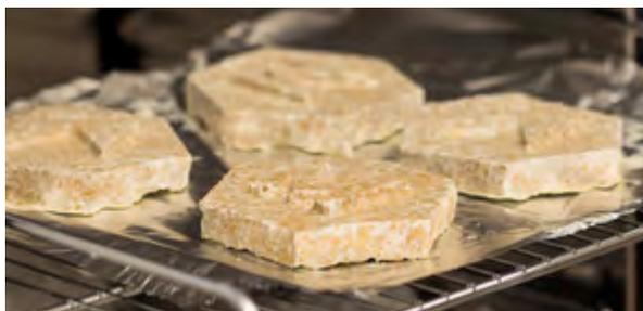
Nach dem Trocknen im Ofen hat der nachhaltige Baustoff ähnliche Dämmwerte wie Styropor; Foto: © Fraunhofer UMSICHT/Julia Kraye
