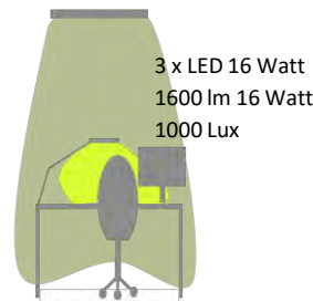
Deckenleuchten mit geringerer Intensität mit Büroleuchte
