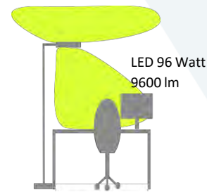
Stehleuchte (im Allgemeinen mit Tageslicht- und Präsenzsensoren ausgestattet).
