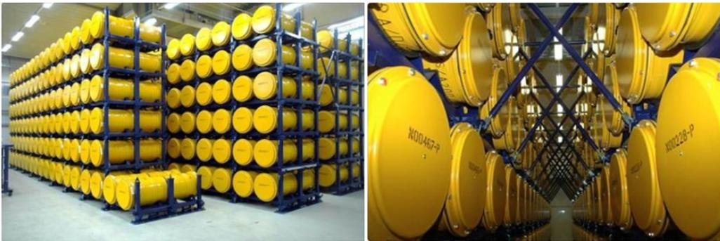
*Abbildung 5: Zwischenlagerung der konditionierten 200 Liter-Fässer*
