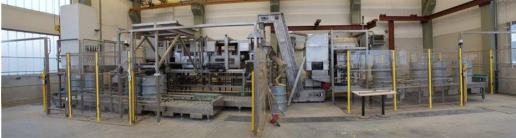
Abbildung 7: Erdmessenanlage (rechts Materialaufbringung, links Messung und Separation)
