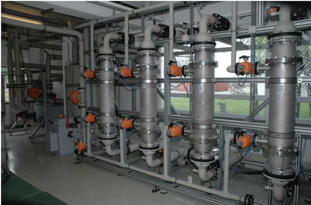
*Abbildung 6: Filtriereinheit der Ultrafiltrationsanlage*
