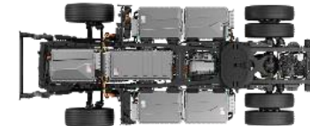
Einbaupositionen Batteriepacks Sattel
