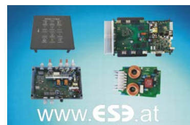
IR sauna cabin control
