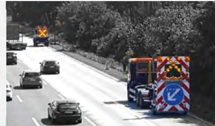
Absicherungsfahrzeug folgt fahrerlos
