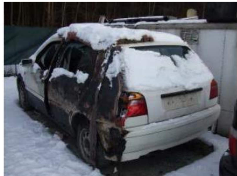
Altfahrzeug mit Brandschaden - gefährlicher Abfall Fire-damaged end-of-life vehicle - hazardous waste (Photo: BMLFUW)
