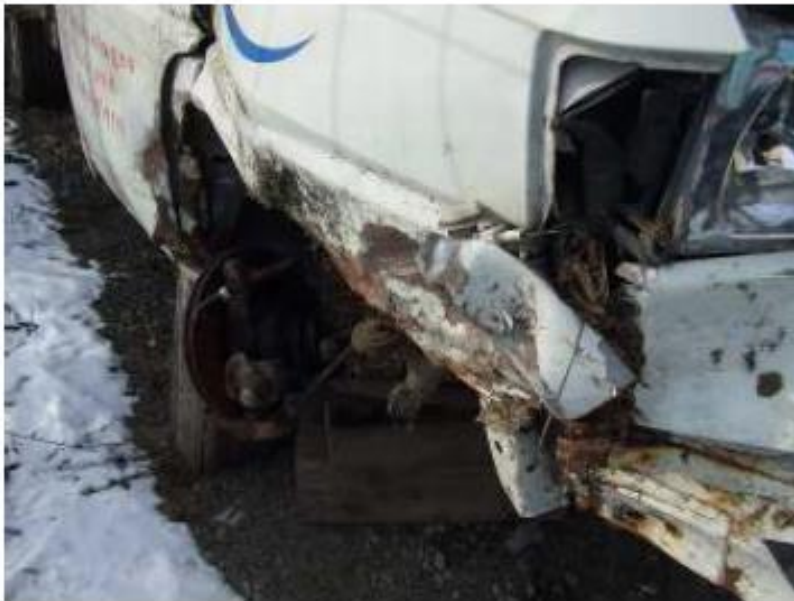
Altfahrzeug mit gebrochener Achse - gefährlicher Abfall End-of-life vehicle with broken axle - hazardous waste (Photo: BMLFUW)
