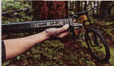
Der Akku in Stangenform liegt innen.
