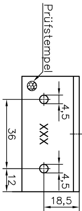
Bohrung mittig vom Ist Maß ausrichten!
