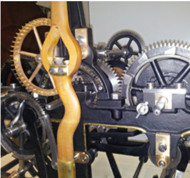
Uhrwerk, bestehend aus ca. 150 Einzelteilen, von Hand restauriert
