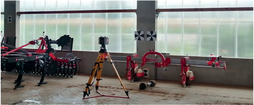
▲ Abbildung 42: Terrestrischer Laserscanner auf Stativ mit Zielmarken 113
