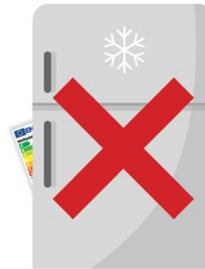
Falsche Platzierung des Energielabels
