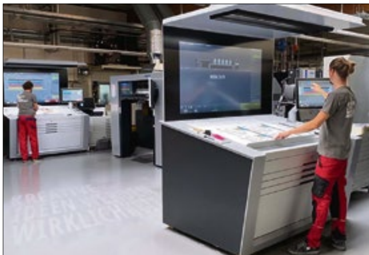
Die vollautomatisierte Produktion der beiden neuen Druckmaschinen wird über einen Leitstand gesteuert und überwacht.
