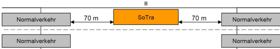
2.12a Das Befahren von Brücken hat mit einer Geschwindigkeit von max. 30 km/h möglichst nahe der Fahrbahntrennung zu erfolgen, wobei zum voran fahrenden und nachfolgenden Verkehr ein Mindestabstand von 70 m einzuhalten ist.
