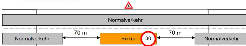
3.13 Das Befahren von Brücken hat mit einer Geschwindigkeit von max. 5 km/h zu erfolgen, wobei zum voran fahrenden und nachfolgenden Verkehr ein Mindestabstand von 70 m einzuhalten ist.
