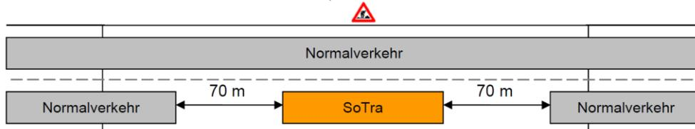
3.12 Das Befahren von Brücken hat mit einer Geschwindigkeit von max. 30 km/h zu erfolgen, wobei zum voran fahrenden und nachfolgenden Verkehr ein Mindestabstand von 70 m einzuhalten ist.
