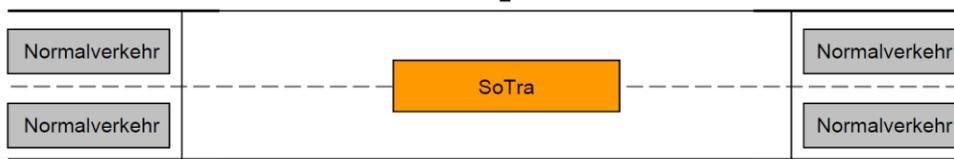
4.22 Das Befahren von Brücken hat mit einer Geschwindigkeit von max. 30 km/h im Alleingang in Brückenmitte zu erfolgen.
