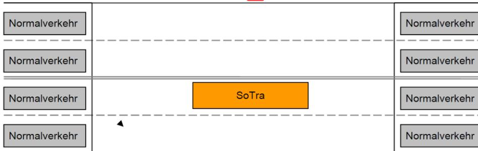
5.22 Das Befahren von Brücken hat mit einer Geschwindigkeit von max. 30 km/h, im Alleingang, möglichst nahe der Fahrbahntrennung zu erfolgen. Der Verkehr in der Gegenrichtung ist anzuhalten.
