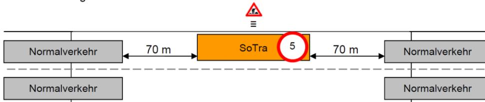
5.21 Das Befahren von Brücken hat im Alleingang möglichst nahe der Fahrbahntrennung zu erfolgen. Der Verkehr in der Gegenrichtung ist anzuhalten.
