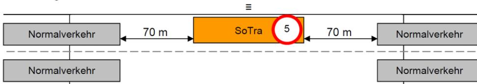
2.21 Das Befahren von Brücken hat im Alleingang möglichst nahe der Fahrbahntrennung zu erfolgen. Der Verkehr in der Gegenrichtung ist anzuhalten.
