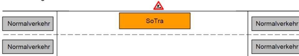
3.22 Das Befahren von Brücken hat mit einer Geschwindigkeit von max. 30 km/h im Alleingang möglichst nahe der Fahrbahntrennung zu erfolgen.
