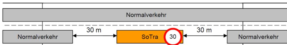
1.13 Das Befahren von Brücken hat mit einer Geschwindigkeit von max. 5 km/h zu erfolgen, wobei zum voran fahrenden und nachfolgenden Verkehr ein Mindestabstand von 30 m einzuhalten ist.
