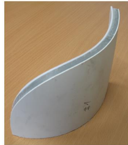
Prüfteil: Abschnitt eines mehrschichtig aufgebauten Kunststoffrohres
