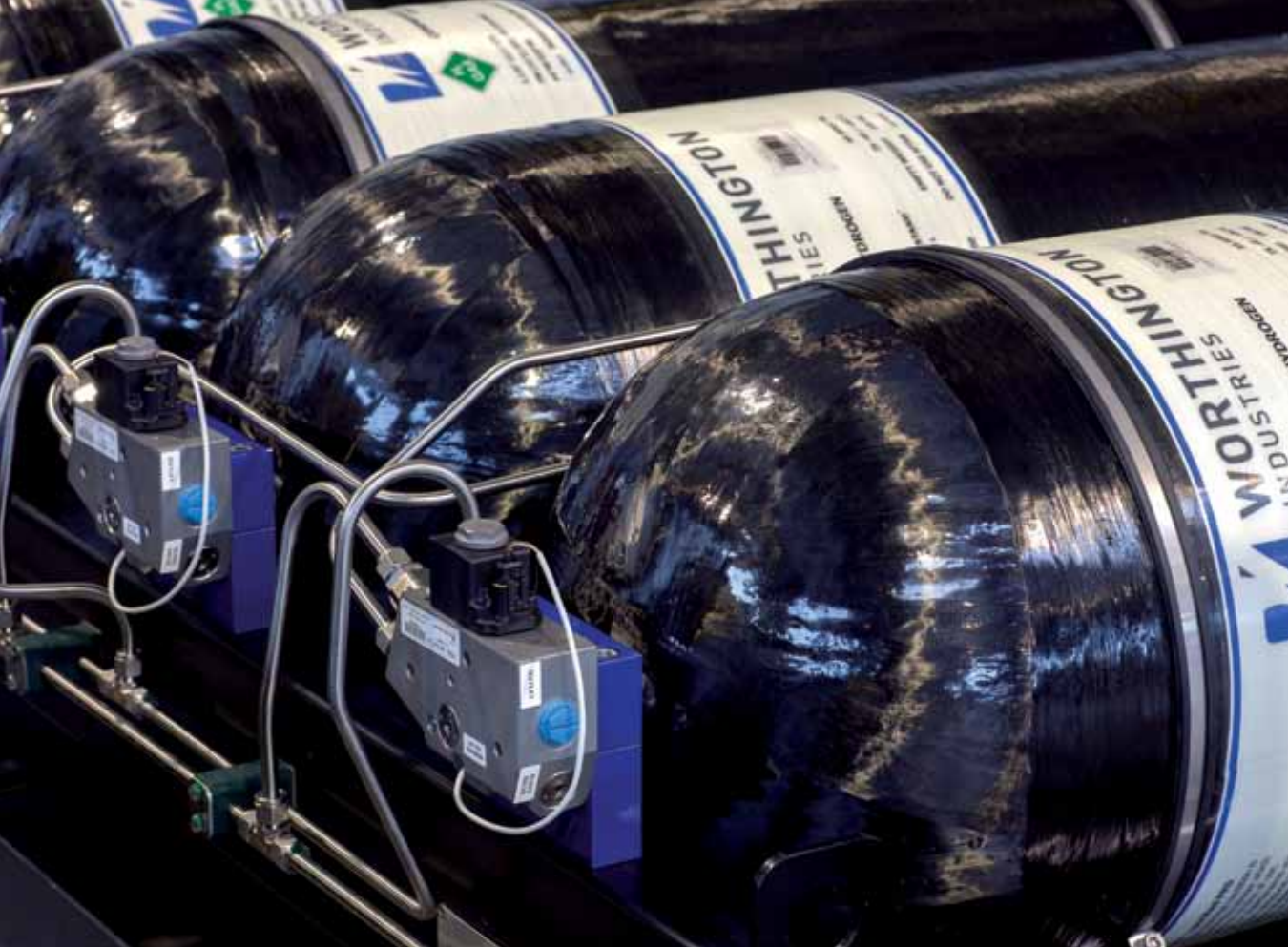
Ventile und Komponenten an Composite-Behältern
