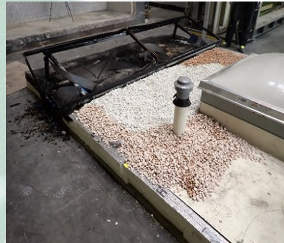
Es erfolgte keine Brandausbreitung oberhalb der Kiesschicht
