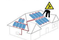
Ohne Optimierer: Hohe Spannung am Hausdach trotz Abschaltung
