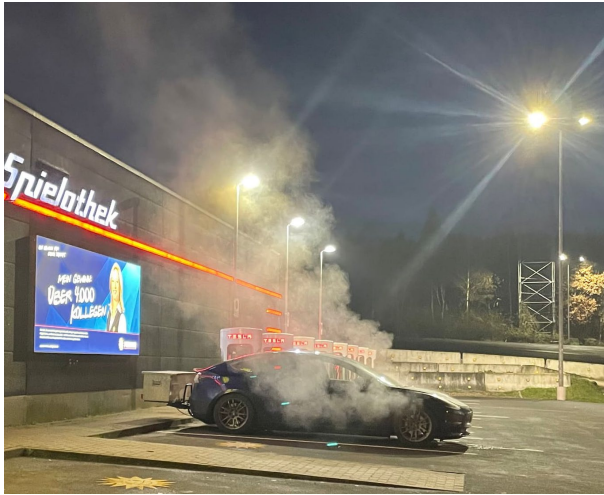
Bild 1: Beispiel für starken Dampfaustritt aus dem Wärmemanagement eines Tesla Model 3 (Quelle: TFF-Forum.de)
