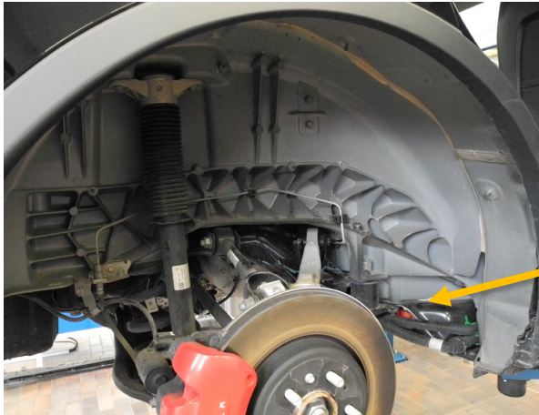
Bild 4: Druckausgleichsventil bei Model Y & 3 an der HV-Batterie hinten rechts
