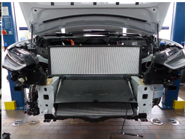
Bild 3: Unter dem Frunk angeordneter Kühler (beispielhaft Model X)
