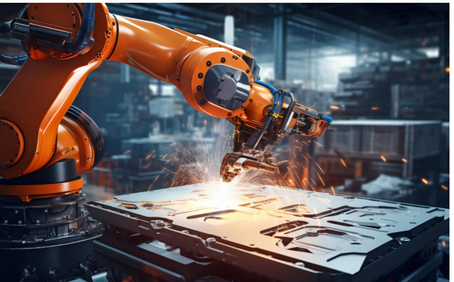
In der Praxis wegweisend ist das CMT-Verfahren, das vor allem im mechanisierten, robotergesteuerten Schweißen zum Einsatz kommt, nicht zuletzt, da es das thermische Fügen von verzinkten Stahl- mit Aluminiumblechen möglich macht und zudem extrem dünne Alu-Bleche ab einer Stärke von 0,3 Millimetern bearbeitet werden können.
