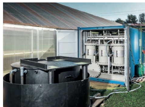
Abb. 26: Pilotanlage zur Stickstoffrückgewinnung (blau) mit Vorlagenbehälter (schwarz) im Feldeinsatz
