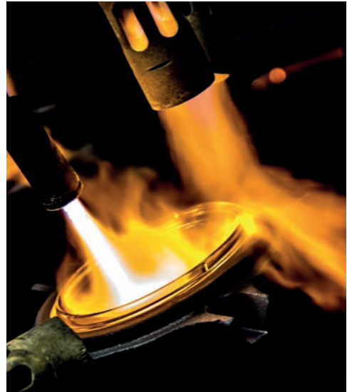
Abb. 40: Feuerpolieren einer gepressten Glasscheibe
