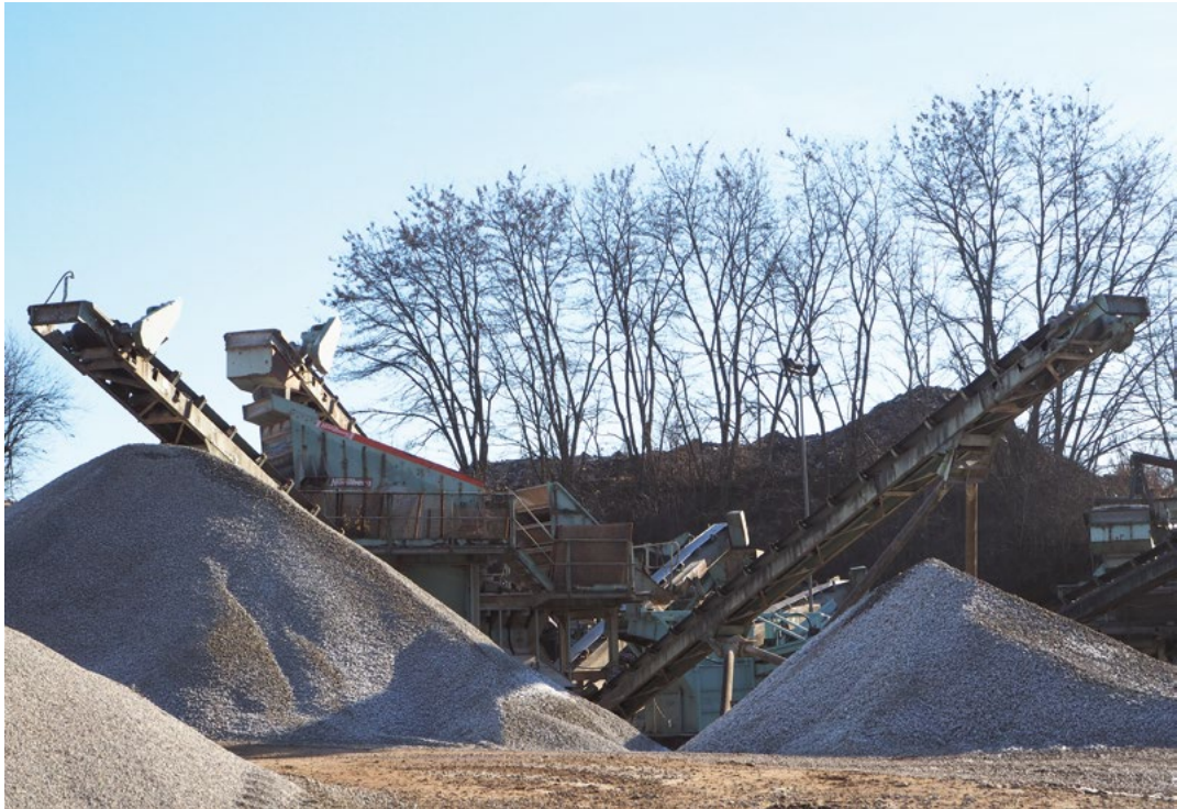
In der Wiederaufbereitungsanlage werden aus den verschiedensten Abbruchmaterialien wieder neue Baustoffe aufbereitet. Umweltstandards werden eingehalten und es wird damit ein wichtiger Beitrag zur Nachhaltigkeit geleistet.
