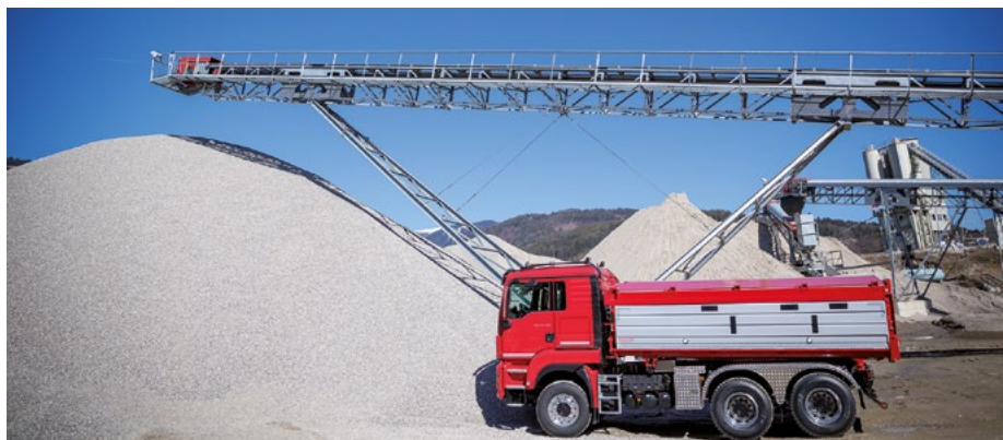
Der Thermokipper ist die innovative Weltneuheit aus dem Hause RESSENIG. Mit dem thermoisolierten Dreiseitenkipper lassen sich Asphalt und andere Mischgüter in einem exakt überwachten Temperaturbereich transportieren.
