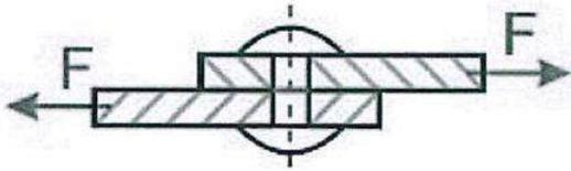
Wie groß muss der Nietdurchmesser  $d$  (in mm) bei 1,7-facher Sicherheit sein?
