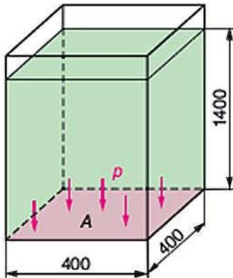
Wie groß ist der Druck  $p$  (in kPa) am Behälterboden?
