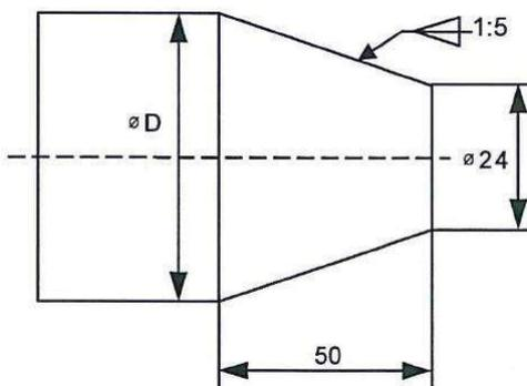
Wie groß ist der Enddurchmesser  $D$  (in mm) des Kegels?
