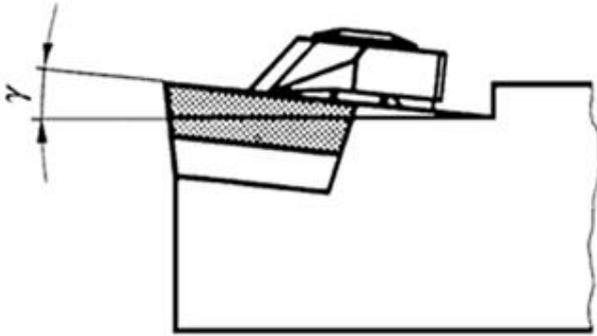
Wie groß muss der Freiwinkel  $\gamma$  (in Grad) der Wendeschneidplatte sein, wenn der wirksame Freiwinkel 7 Grad betragen soll und die Wendeschneidplatte mit einer positiven Neigung von 6 Grad eingespannt ist?
