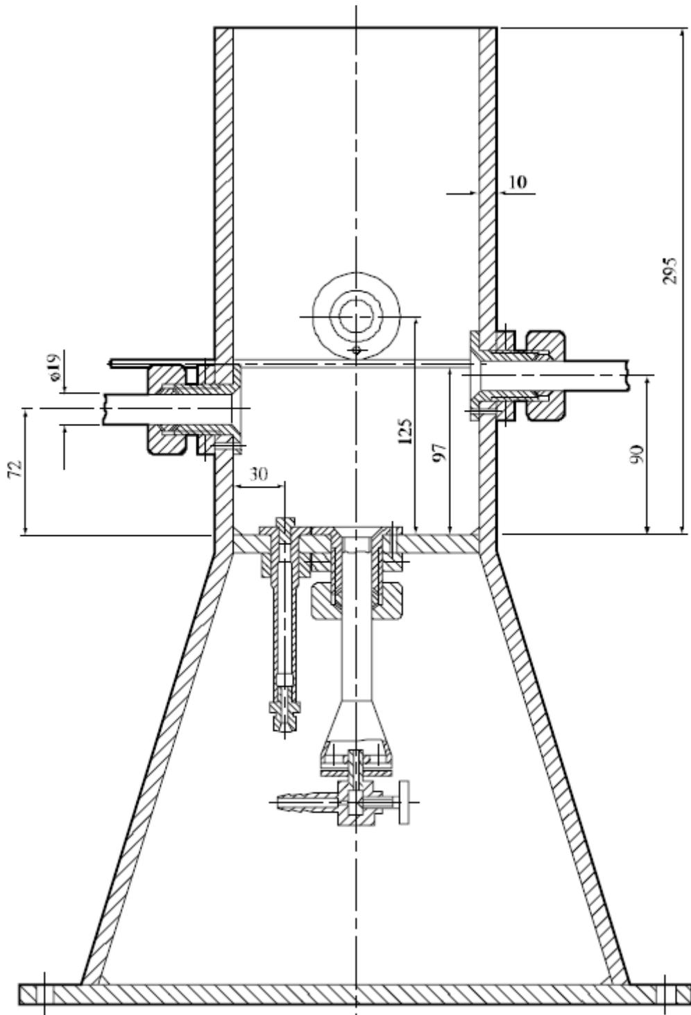
**Abbildung 12.5.1.2: ERWÄRMUNGS- UND SCHUTZVORRICHTUNG**
