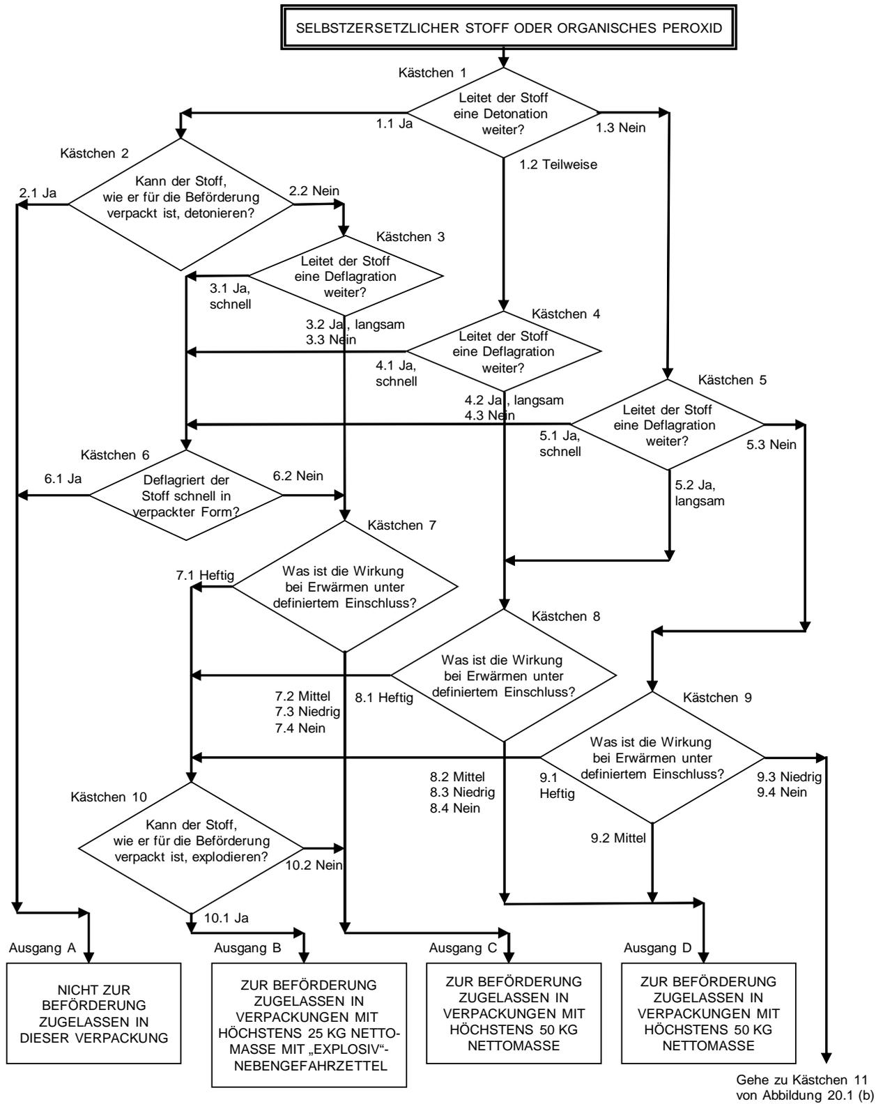
**Abbildung 20.1 (b): FLIESSDIAGRAMM FÜR SELBSTZERSETZLICHE STOFFE (SR) UND ORGANISCHE PEROXIDE (OP) (Fortsetzung)**
