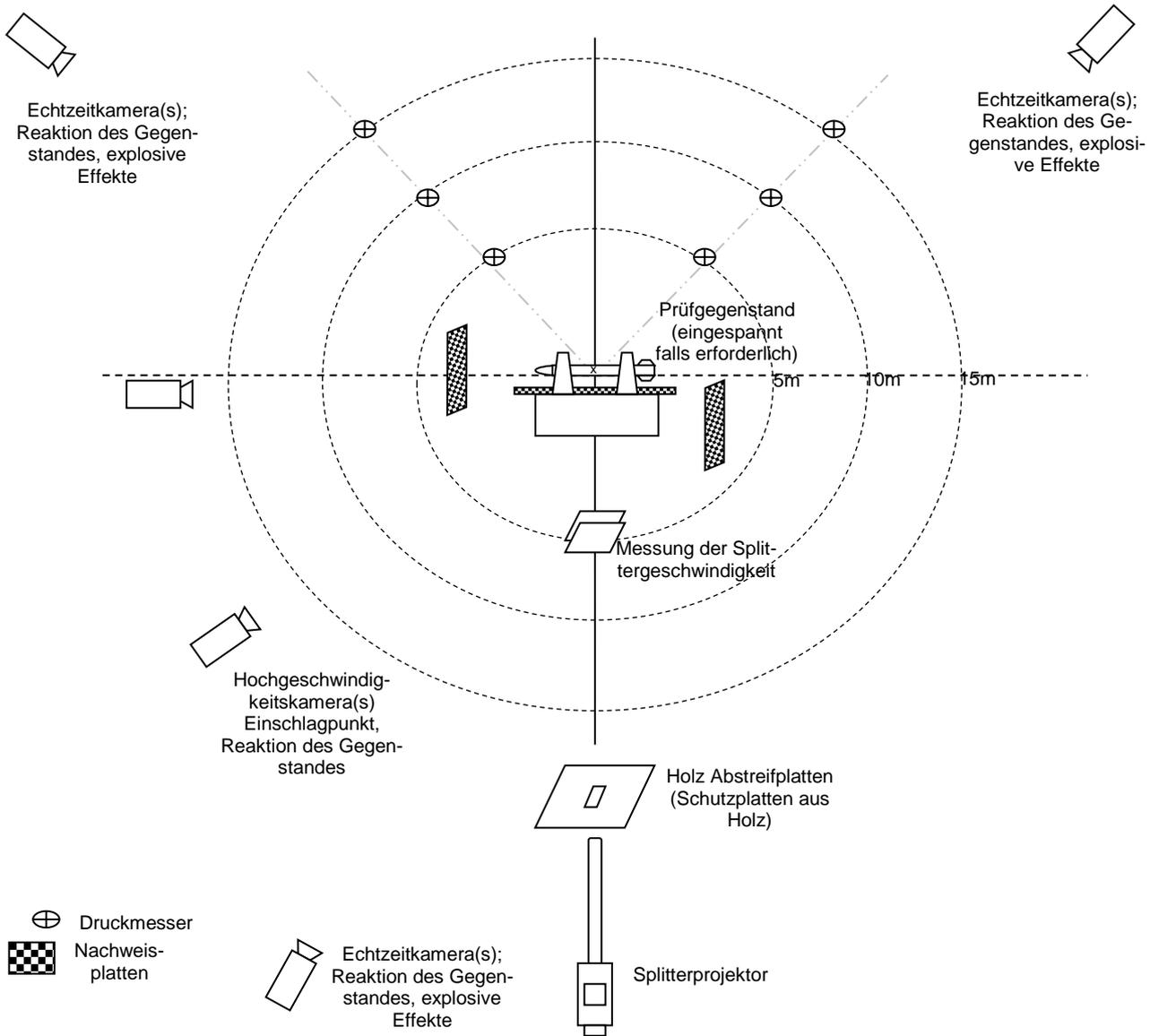
**Abbildung 17.14.2: TYPISCHER AUFBAU FÜR DIE 1.6 GEGENSTAND SPLITTEREINSCHLAGPRÜFUNG**
