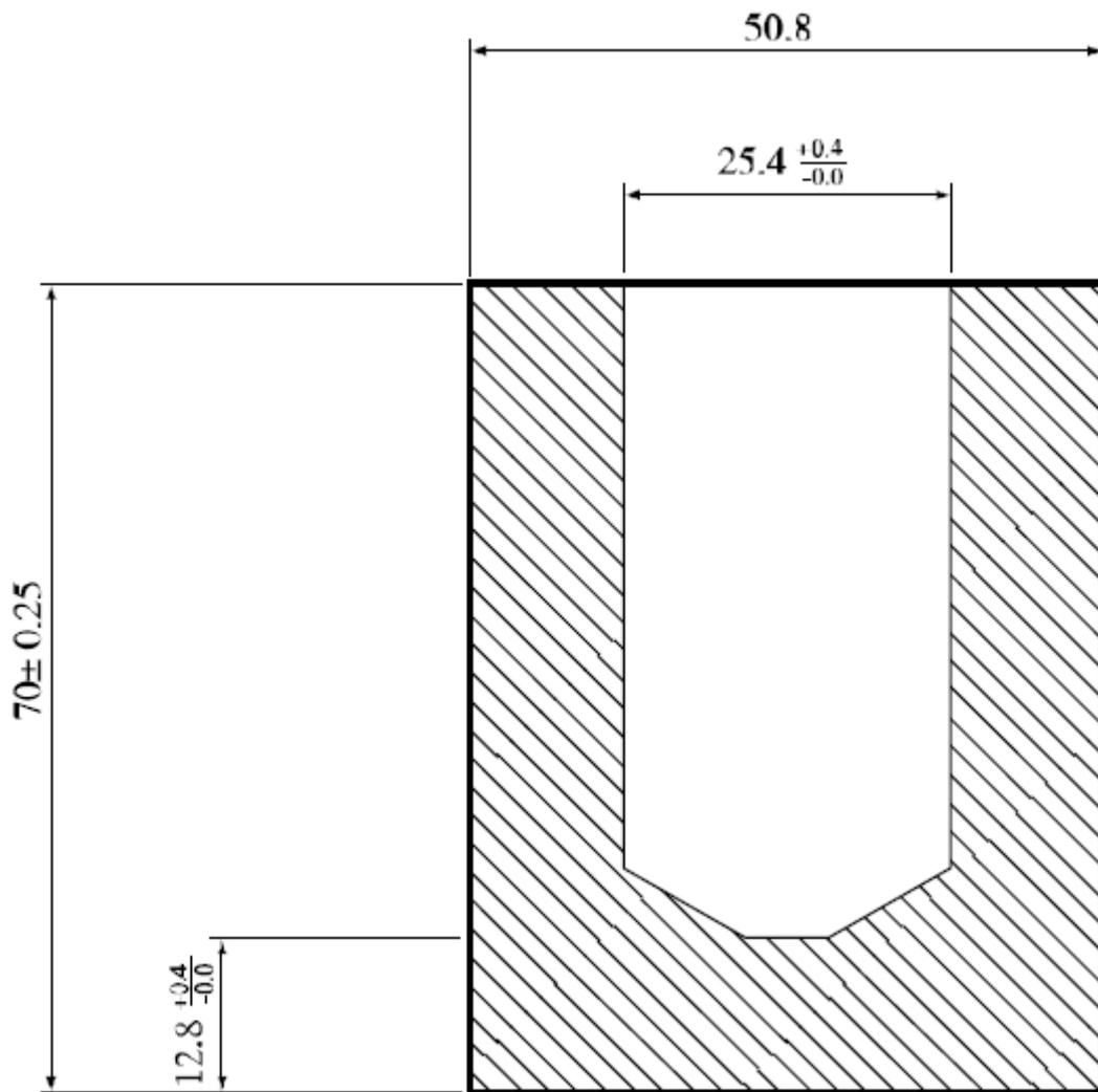
Abbildung 26.4.4.1: MODIFIZIERTE TRAUZL-PRÜFUNG
