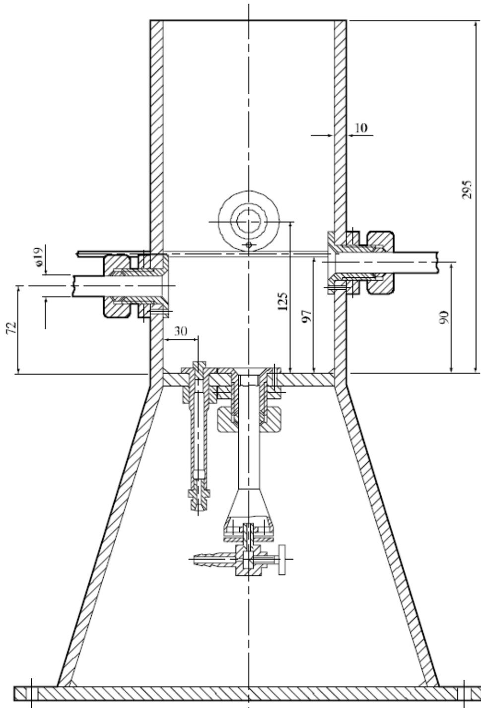
**Abbildung 25.4.1.2: ERWÄRMUNGS- UND SCHUTZVORRICHTUNG**
