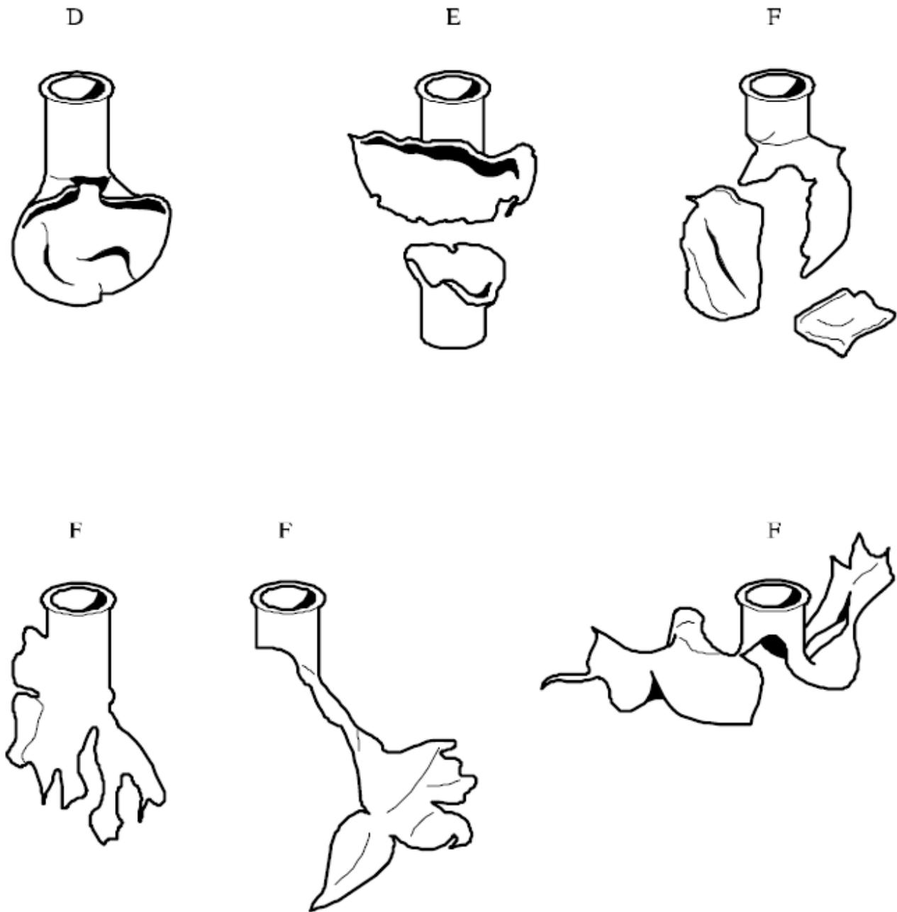
**Abbildung 25.4.1.3: BEISPIELE DER ZERLEGUNGSARTEN D, E und F**
