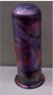
“B”: Stahlhülsenboden und -wand aufgebeult
