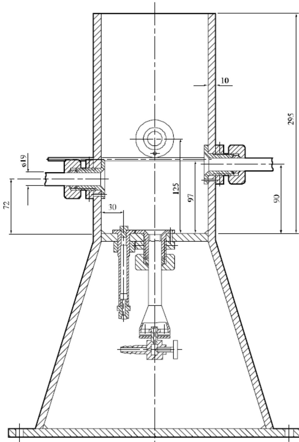
**Abbildung 11.5.1.2: ERWÄRMUNGS- UND SCHUTZVORRICHTUNG**
