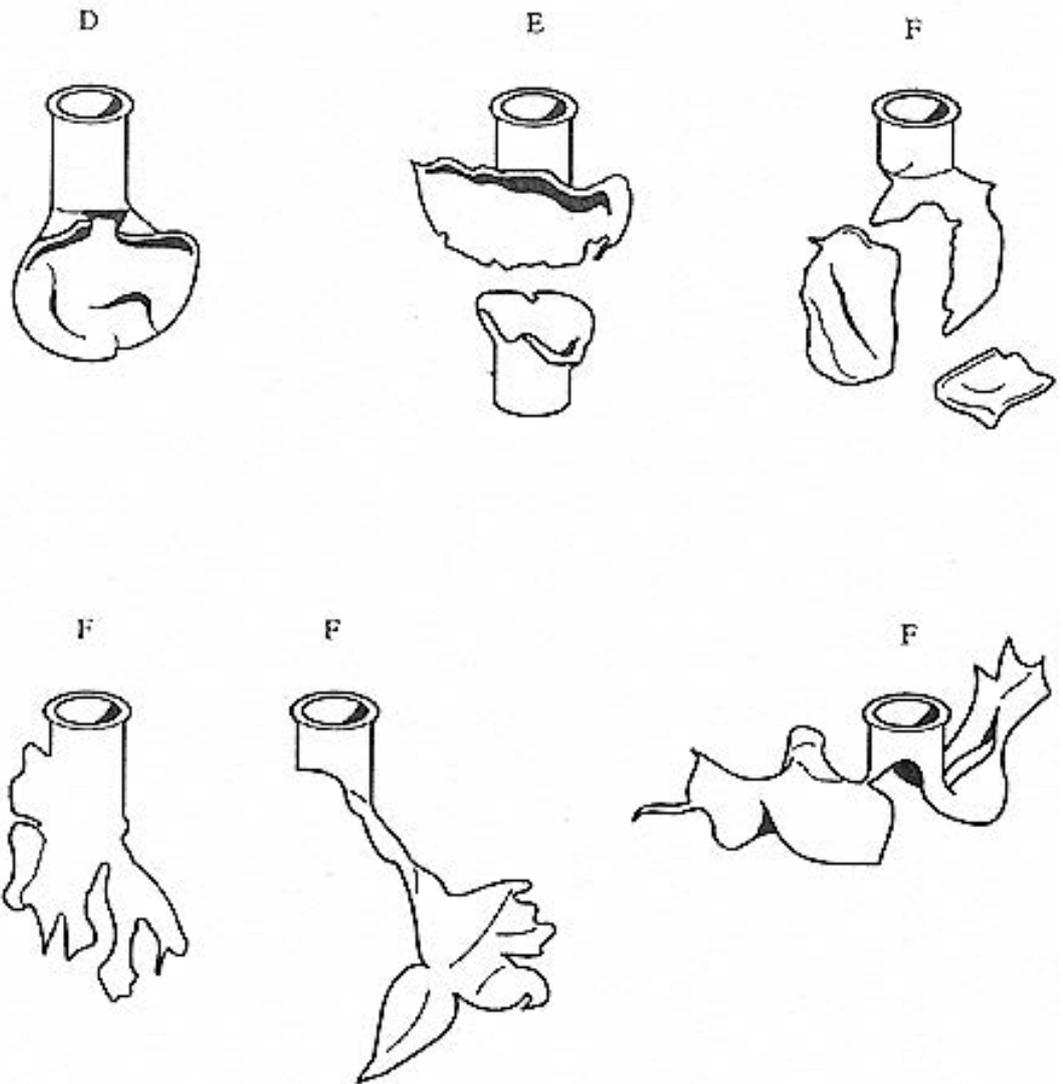
**Abbildung 18.6.1.3: BEISPIELE FÜR ZERLEGUNGSARTEN D, E UND F**
