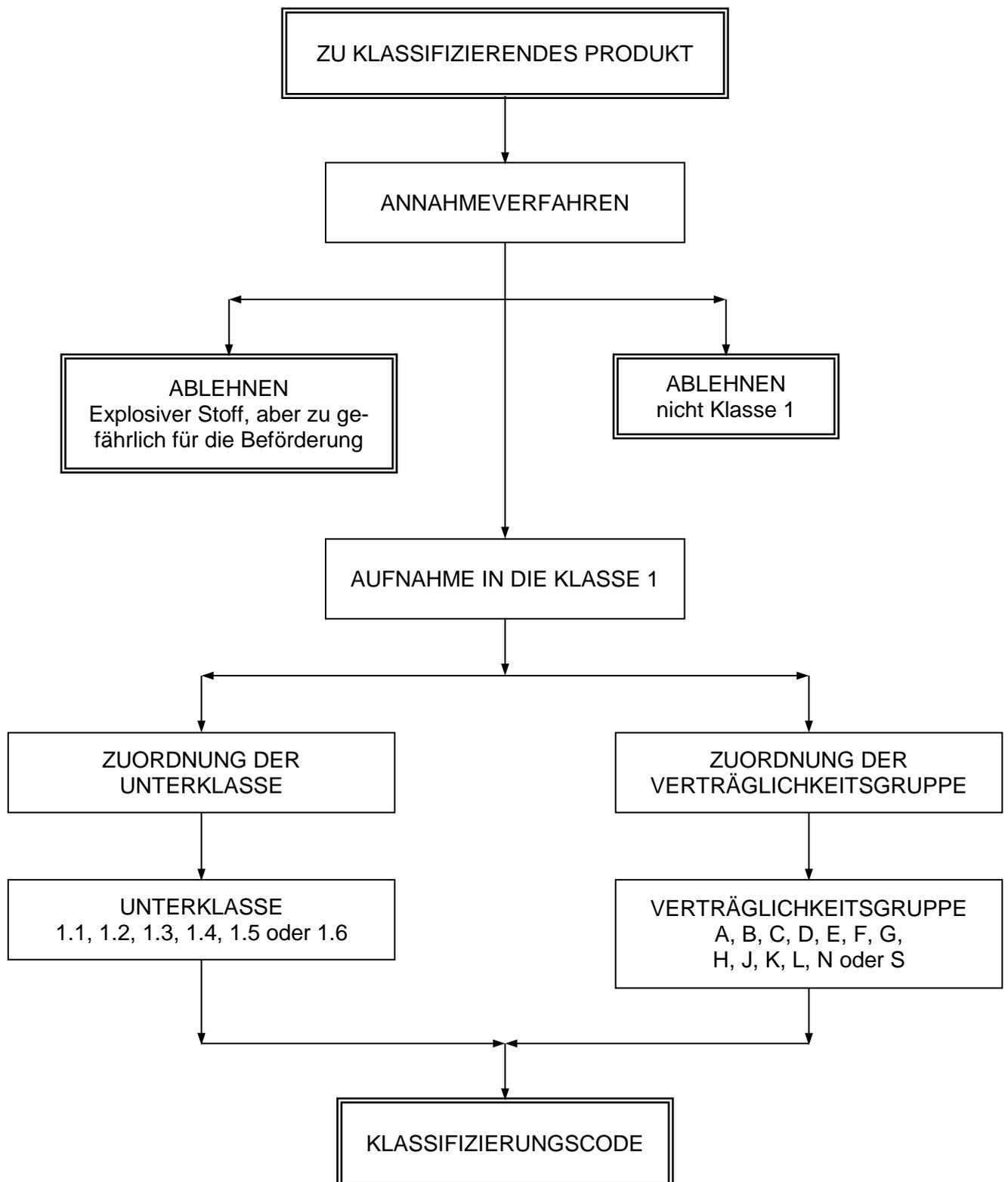
Abbildung 10.2: VERFAHREN ZUR VORLÄUFIGEN ZUORDNUNG EINES STOFFES ODER EINES GEGENSTANDES ZUR KLASSE 1
