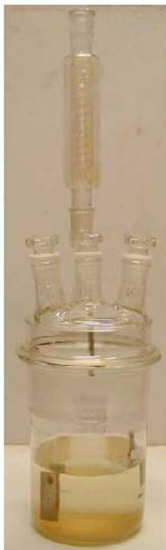
**Abbildung 37.4.2: AUSLAGERUNGSGEFÄSS MIT RÜCKFLUSSKÜHLER**
