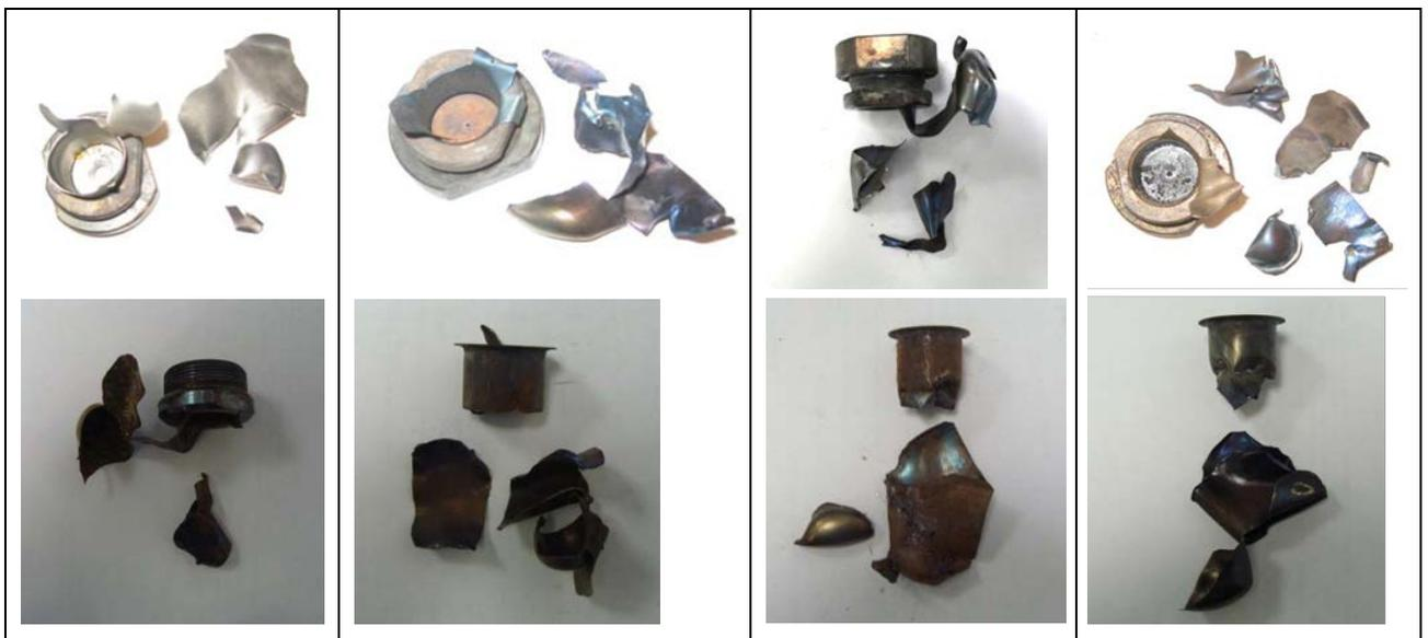
**“G”:** Stahlhülse in viele, sehr kleine Teile zerlegt, Verschraubung unbeschädigt
