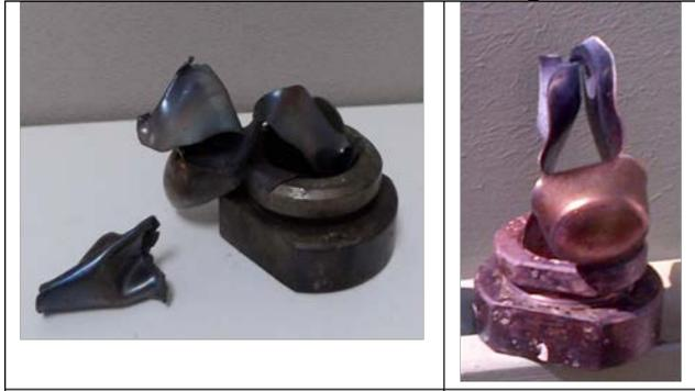
**“F”:** Stahlhülse in drei oder mehr, hauptsächlich große Teile zerlegt, die in einigen Fällen durch einen schmalen Streifen miteinander verbunden sein können;
