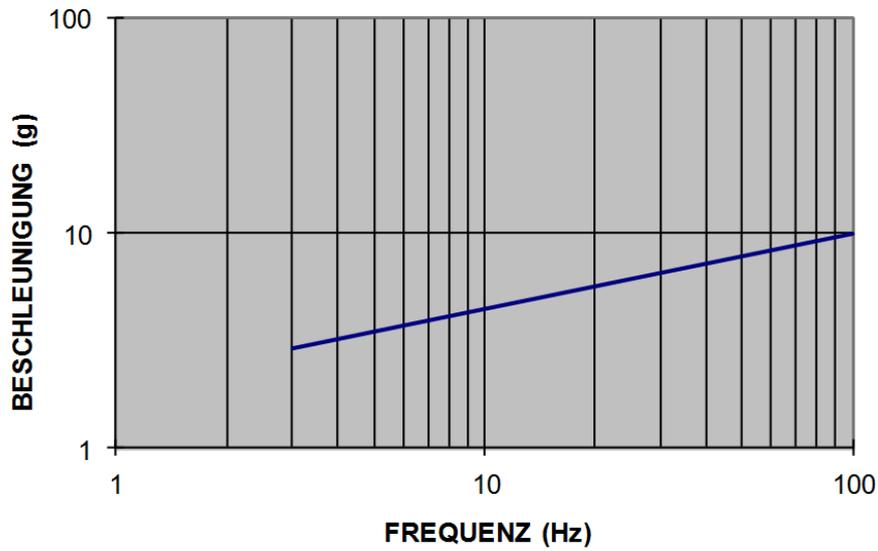
Gleichung für die Erzeugung der oben dargestellten Minimum-SRS-Kurve:  $ACCEL = 1.95 \text{ FREQ}^{0.355}$
