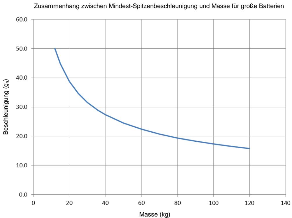
**Abbildung 38.3.4.2 Zusammenhang zwischen Mindest-Spitzenbeschleunigung und Masse für große Batterien (gleich oder mehr als 12 kg)**
