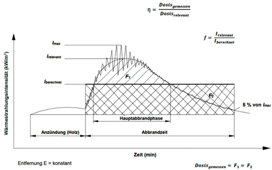
Abbildung 51.4.1: Messung der Wärmestrahlung als Funktion der Zeit
