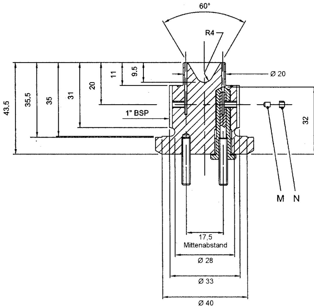
**Abbildung A7.8: ZUSAMMENGEBAUTER ANZÜNDSTOPFEN MIT KONUS**
