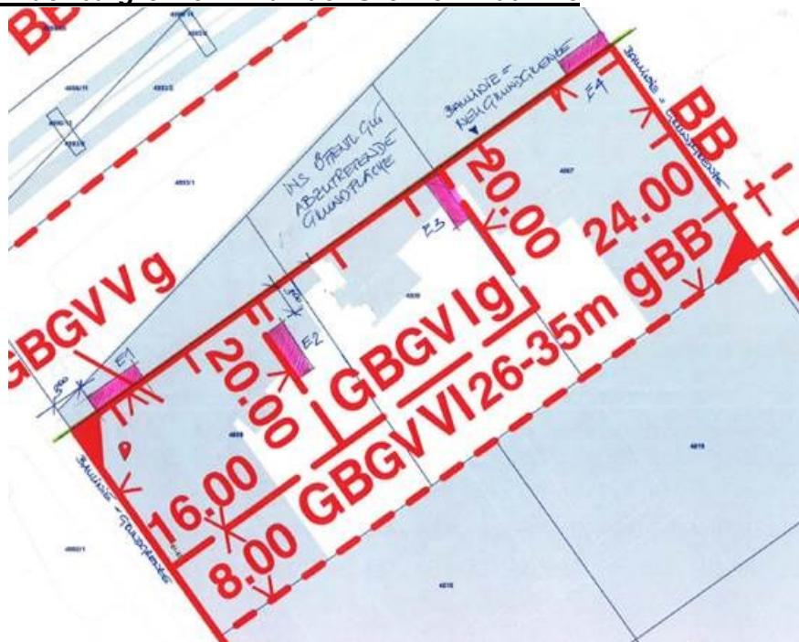
***Einhaltung der 3m zu Nachbargrenze: Sind in unten aufgezeigtem Fall alle 4 Erkervarianten zulässig? Wie sind die Eckbereiche zu lösen?***
