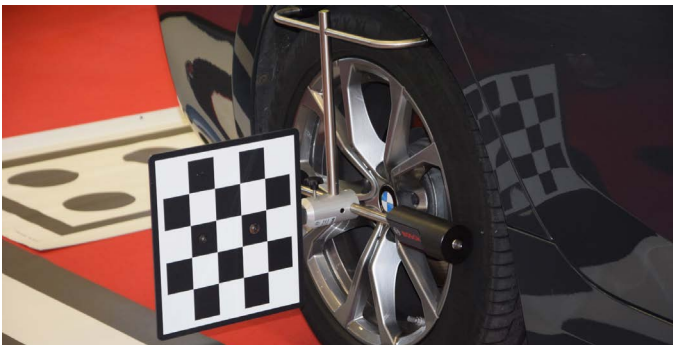
Kalibrierung ist das beste Beispiel für Auslagerung von Dienstleistungen aus dem eigenen Karosseriefachbetrieb zum Spezialisten. Foto: 4rad Werbeagentur
