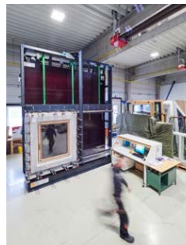
Ein moderner Prüfstand zur messtechnischen Ermittlung örtlicher Leckagen.
