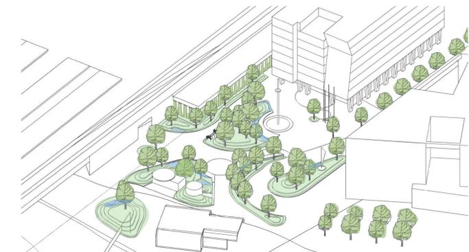
Intensiv bepflanzte grüne Inseln mit **klimaresilienten** Baumarten erzeugen Schatten, Kühlungs- und Durchlüftungseffekte. Mulden fungieren bei Starkregenereignissen als Retentionsvolumen und gewährleisten eine schadhlose Überflutung des Platzes.
