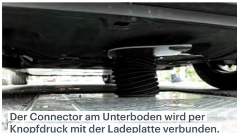
Der Connector am Unterboden wird per Knopfdruck mit der Ladeplatte verbunden.
